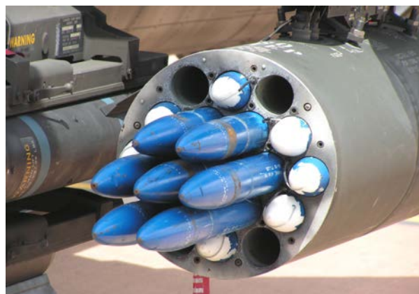
Ракеты "Гидра-70" в 19-зарядной пусковой установке
