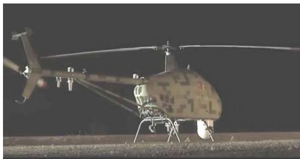
Разведывательный БЛА AV500, оснащенный ОЭ/ИК-турелью, на ночных учениях
