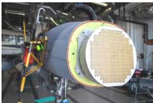
РЛС с АФАР X-диапазона фирмы SAAB на двухместном самолёте "Грипен D"
