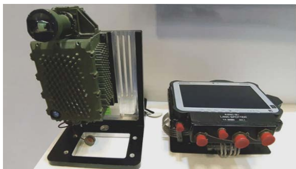
Компоненты системы "Лэнд Споттер": датчик FLIR (слева) и блок ЧМИ
