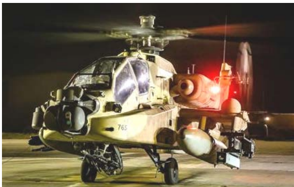
Боевой вертолёт AH-64D "Апач" с ракетой "Спайк" NLOS на пусковой установке внешней центральной подвески крыла
