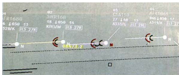
Индикация интервалов эшелонирования и взаимного расположения самолётов при заходе на посадку на устройстве LORD
