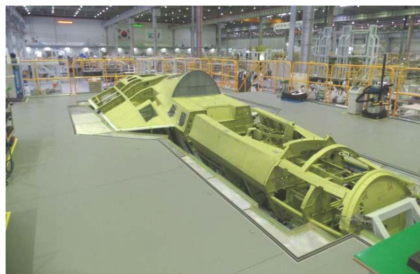
Фюзеляж первого прототипа KF-X в сборочном цехе фирмы KAI в Сачхоне
