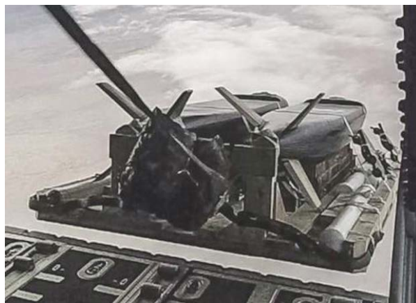
Сброс двух ракет CLEAVER на транспортном поддоне
