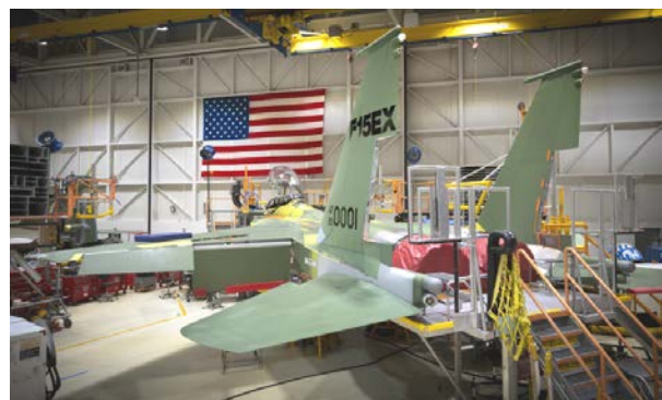
Первый образец истребителя F-15EX в процессе сборки
