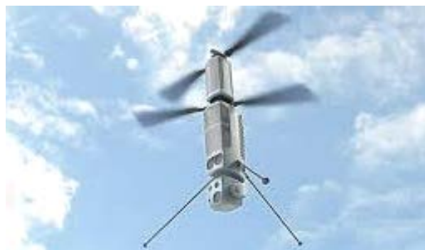
Барражирующий боеприпас "Файрфлай" компании Рафаэль с вертикальными взлётом и посадкой
