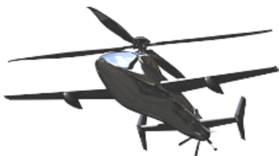
Модель вертолёта CHITA обычной конфигурации с несущим винтом замедленного вращения
