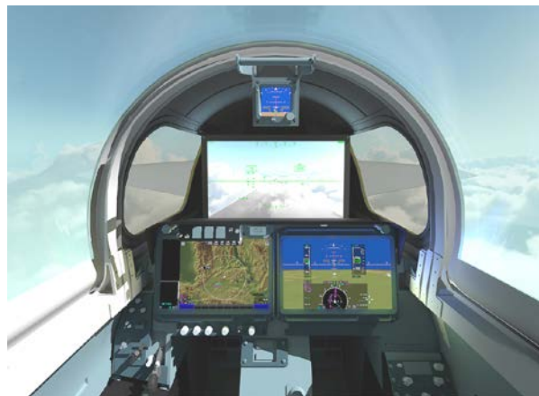
Кабина X-59 QueSST с 4К-монитором переднего обзора
