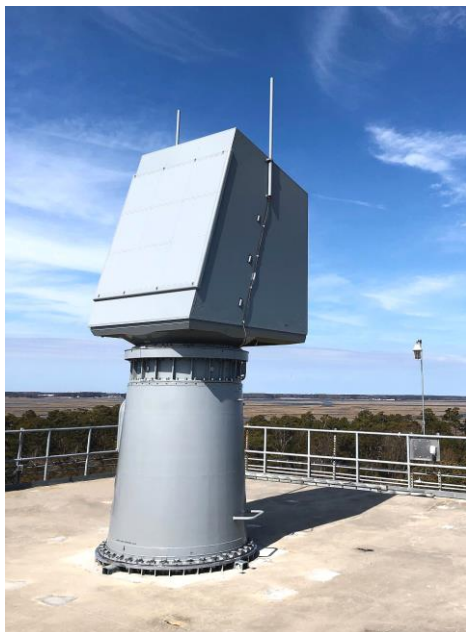
Экспериментальный образец РЛС воздушного наблюдения SPY-6(V)2
