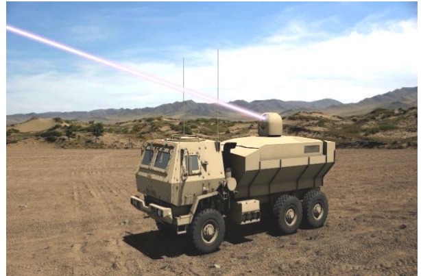
Автомобильная платформа с демонстратором тактического лазера HEL TVD компаний Дайнетикс и Локхид Мартин
