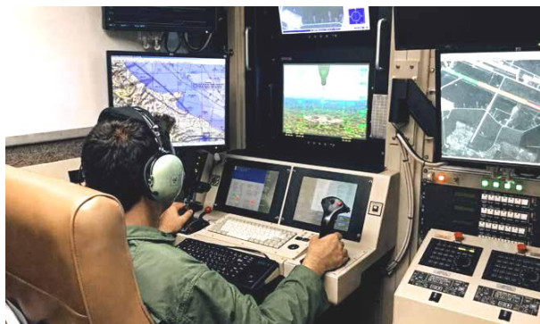
Тренажёр компании CAE для подготовки операторов БЛА "Предейтор" с нулевым налетом
