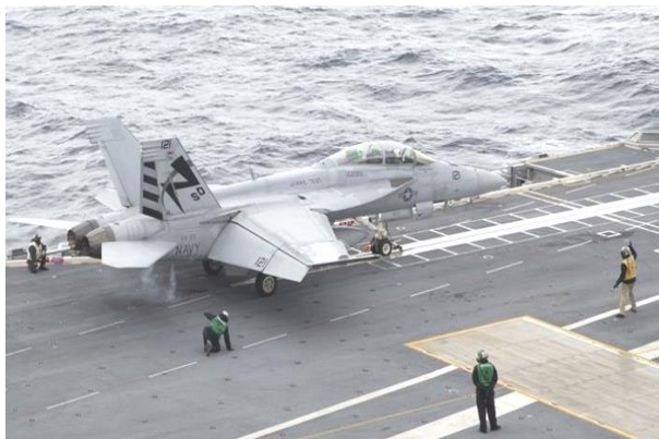
Использование систем EMALS и AAG для запуска и посадки истребителя F/A-18F на авианосце "Джеральд Форд"
