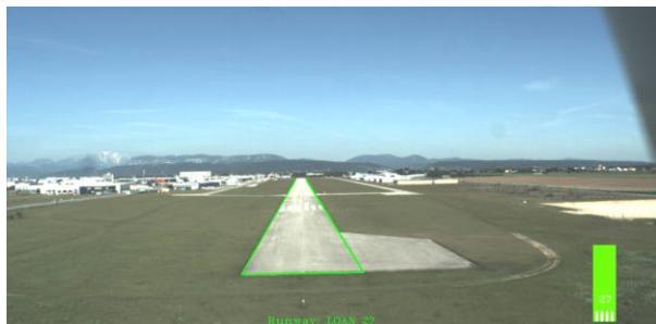
Автоматическая посадка самолёта DA42 с использованием навигационной системы с техническим зрением
