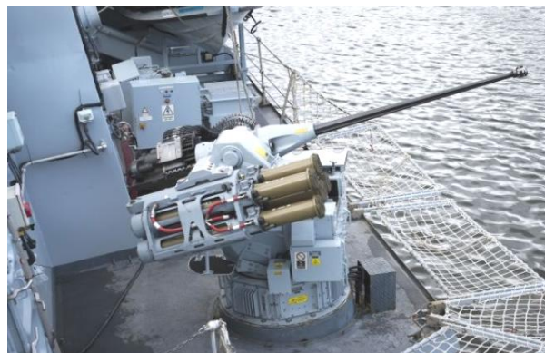
Пусковой контейнер на пять ракет LMM/"Мартлет", установленный совместно с 30-мм пушкой DS30M Mk 2 на борту фрегата "Сазерленд"
