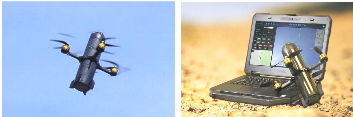
БЛА-камикадзе "Дроун Буллет" в полете (слева) и в комплекте с наземной станцией
