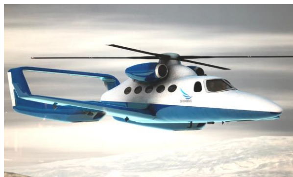
Концепция винтокрыла "ВертиДжет" с небольшими концевыми реактивными двигателями
