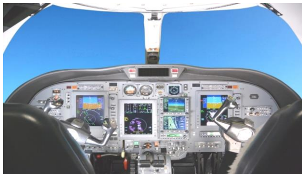
Дисплей IFD540 фирмы Авидайн в кабине самолёта "Ситейшн"
