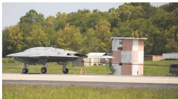
Посадка ББС X-47 с помощью аэрофинишера
