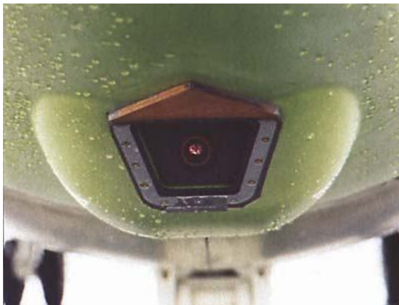
Датчик системы улучшенного видения EVS, установленный под фюзеляжем самолета "Гольфстрим 5".
