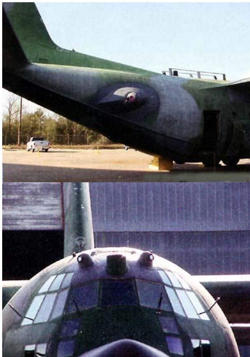
Устройства сопровождения целей и наведения луча передатчика помех (а), два из четырех датчиков системы предупреждения об атаке (б).
