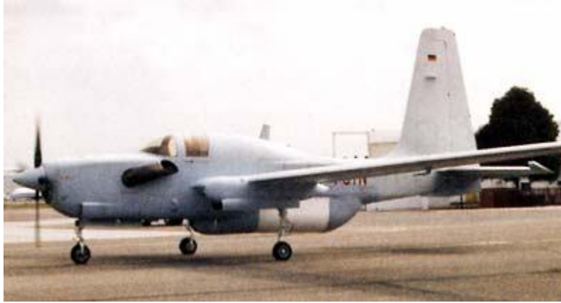
Самолет "Гроб" фирмы Эгре с установленной РЛС HISAR.
