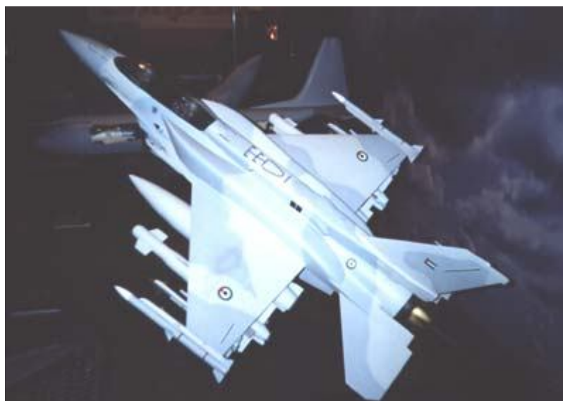
Конфигурация самолета F-16 Блок 60 с конформными топливными баками и с конформным отсеком системы РЭП.
