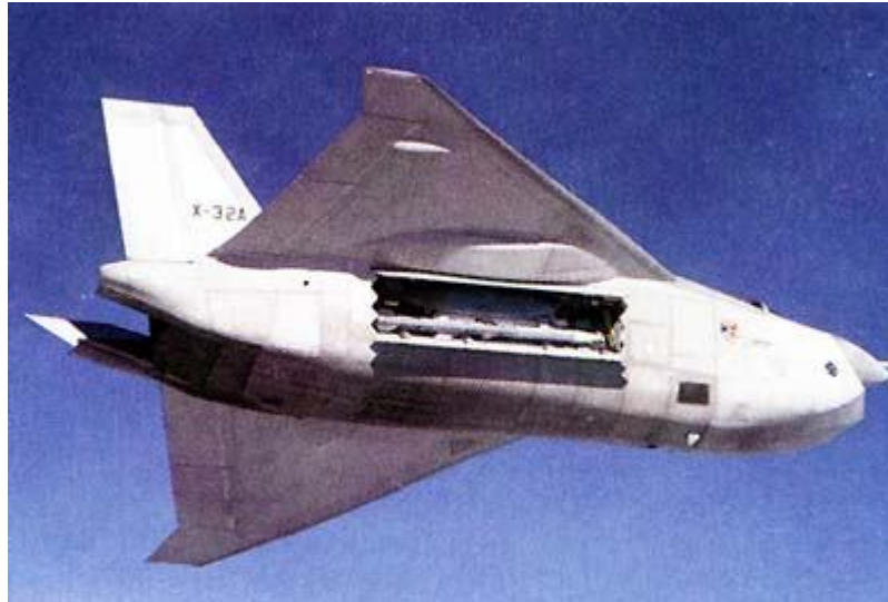
Ракета класса "воздух-воздух" AMRAAM во внутрифюзеляжном отсеке самолета X-32A.
