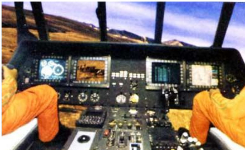
Модернизированная кабина вертолета Ми-17.
