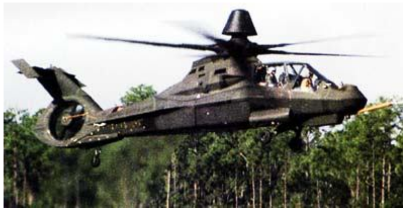
Модифицированный вертолет RAH-66 "Команч" с новой хвостовой частью.
