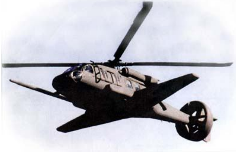
Вертолет "Си Хок" с воздушным винтом VTDP и несущим крылом.
