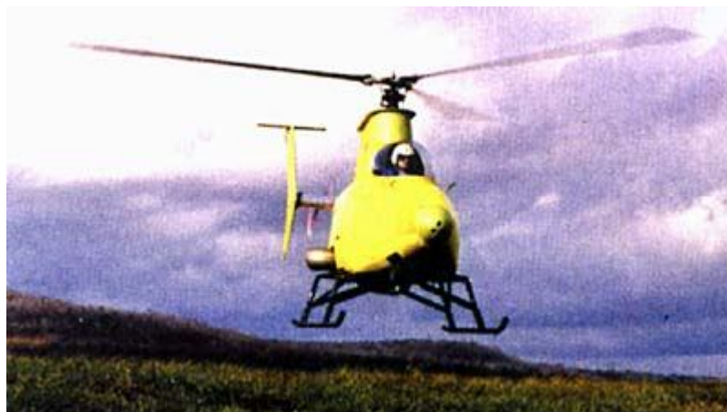
Пилотируемый образец разрабатываемого БЛА "Файрскрут".
