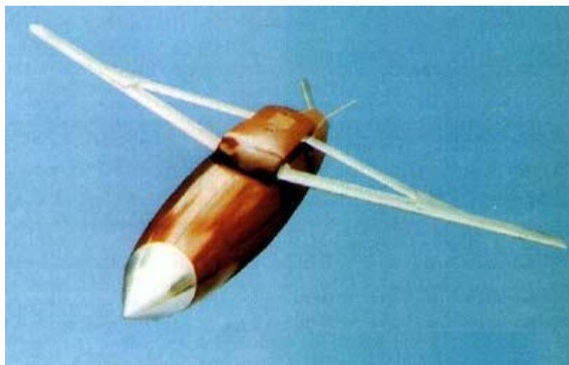
Высокоточная система оружия JDAM с комплектом крыльев "Дайамонд Бэк".
