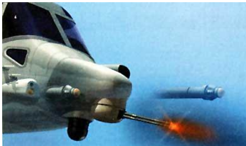
Размещение турельной системы TGS на винтоплане MV-22 "Оспри" (заправочная штанга показана в убранном и рабочем состояниях).
