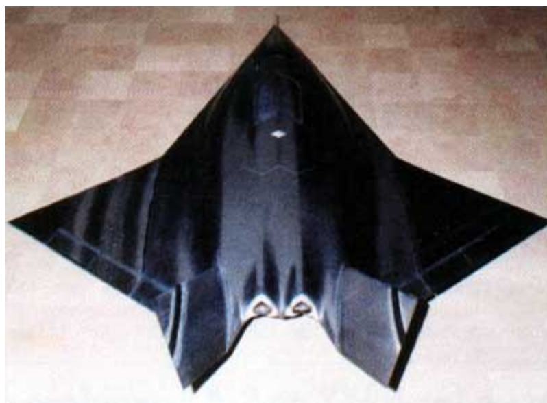
Конфигурация малозаметного ББС "Пти Дюк" фирмы Дассо.
