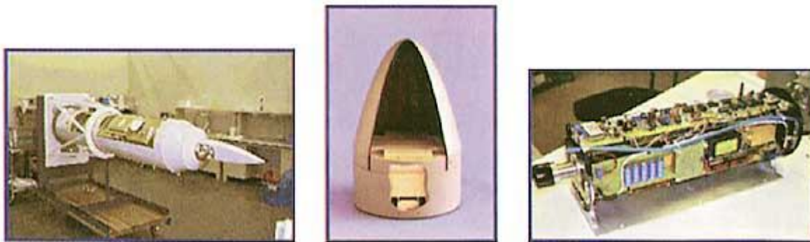
Варианты ГСН для перехватчика крылатых ракет MALI: радиолокационная ГСН с шумоподобным зондирующим сигналом NRS (слева); радиолокационная ГСН с электронным сканированием и микроэлектромеханической системой MES ESA) (в центре); активная лазерная ГСН (ладар).
