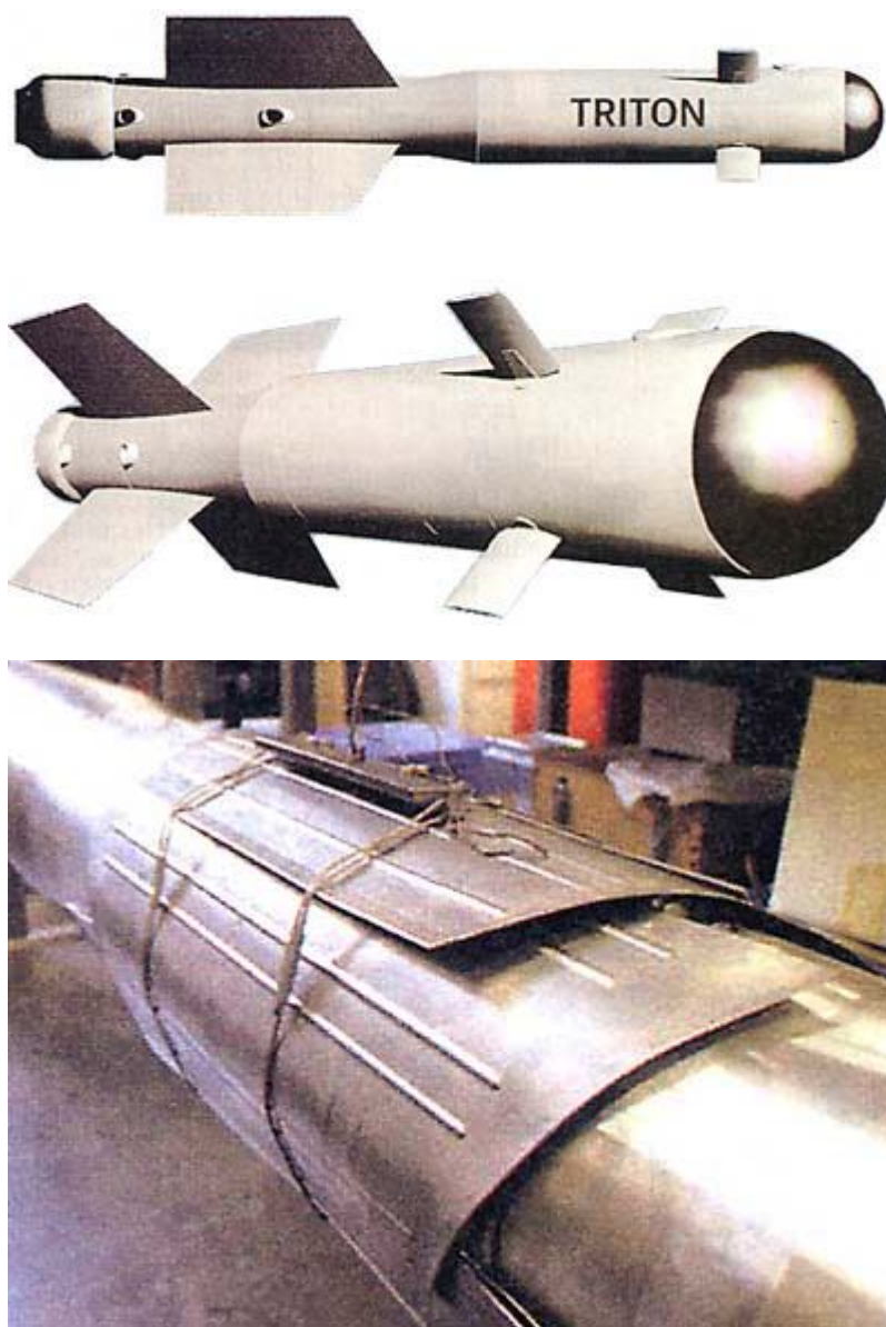
Управляемая ракета "Тритон" (вверху) и ее складывающиеся крылья.
