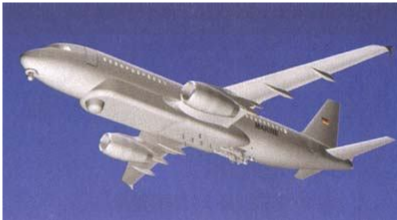
Конфигурация морского патрульного/противолодочного самолета на основе самолета А320.
