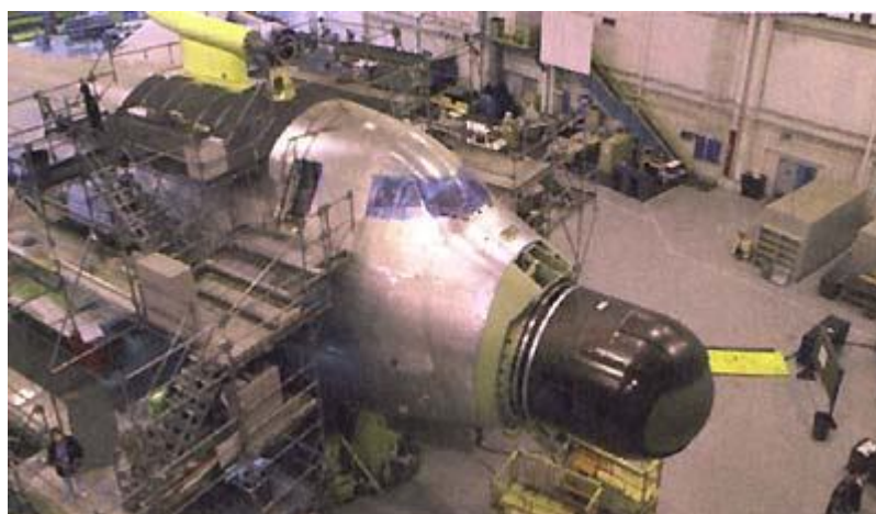
Установка на самолете YAL-1A турели и лазерного дальномера (наверху фюзеляжа) оружия ABL.
