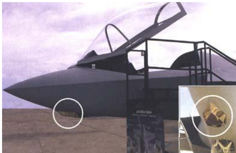
Линза лазерного дальномера, выступающая из фюзеляжа самолета F-35.
