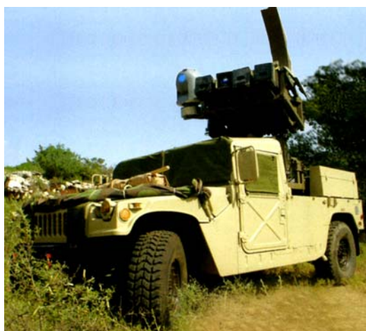
Пусковая установка УР "Спайк-NLOS", установленная на лёгкой боевой машине
