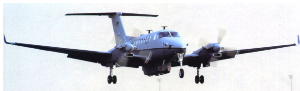
Самолёт MC-12W с подфюзеляжным контейнером для размещения видеокамер
