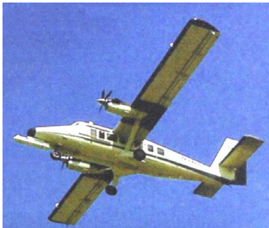
РЛС VADER, установленная под носовой частью самолёта DHC-6 "Твин Оттер"
