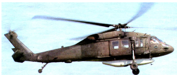
Лётные испытания датчика ARGUS-IS на вертолёте "Блэк Хок"
