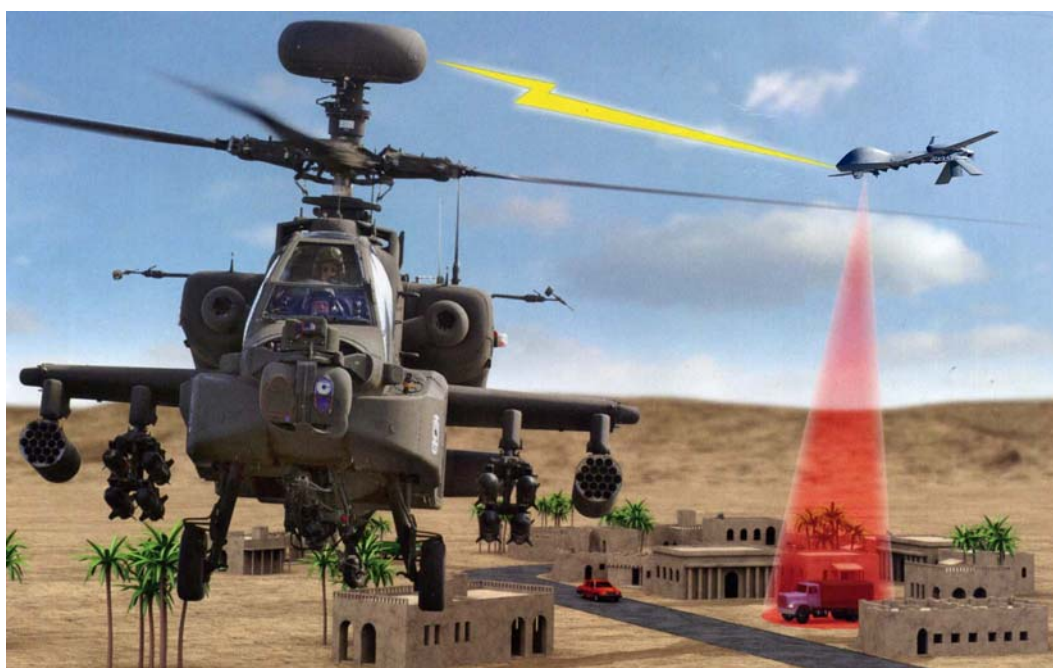
ЛПД УТА, осуществляющая связь вертолёта АН-64D Блок III с БЛА
